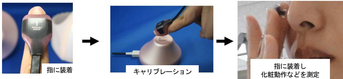
図1 今回開発した「指センサー」(ウェアラブル接触力センサー HapLog (ハプログ、Haptic Skill Logger))
